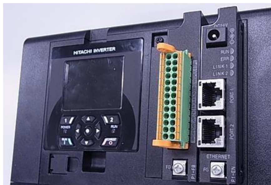
Hình 2.10: Các module option của biến tần SJ-P1.
